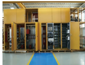
Simon Bolivar, Venezuela Système d'excitation THYNE6 pour niveau haute tension Puissance de la centrale: 6x 805 MVA
